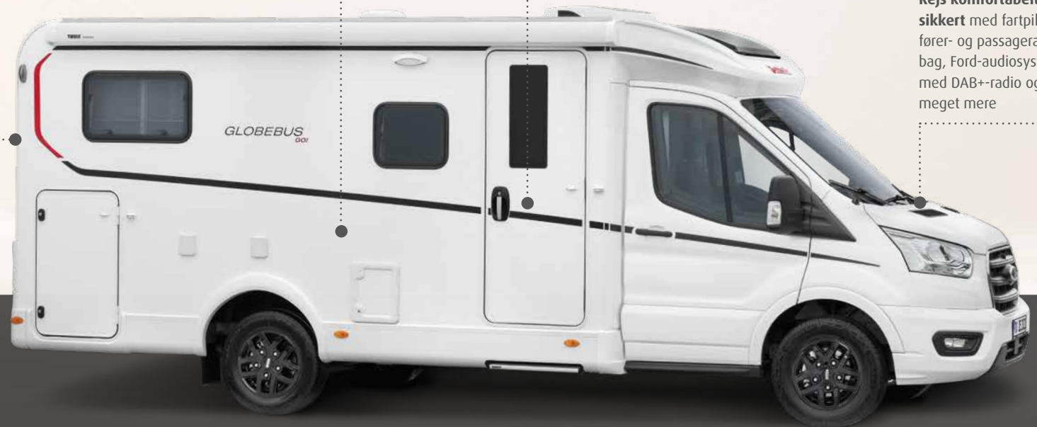
Tag, bagende og sidevægge af modstandsdygtig GFK.
