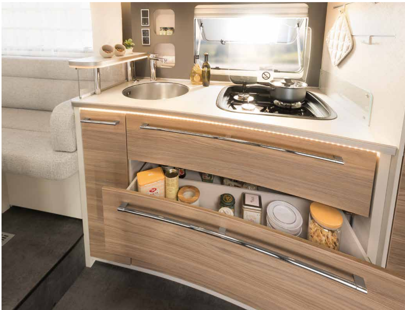
De store skuffer har en elektrisk centrallås og låses automatisk ved motorstart.
