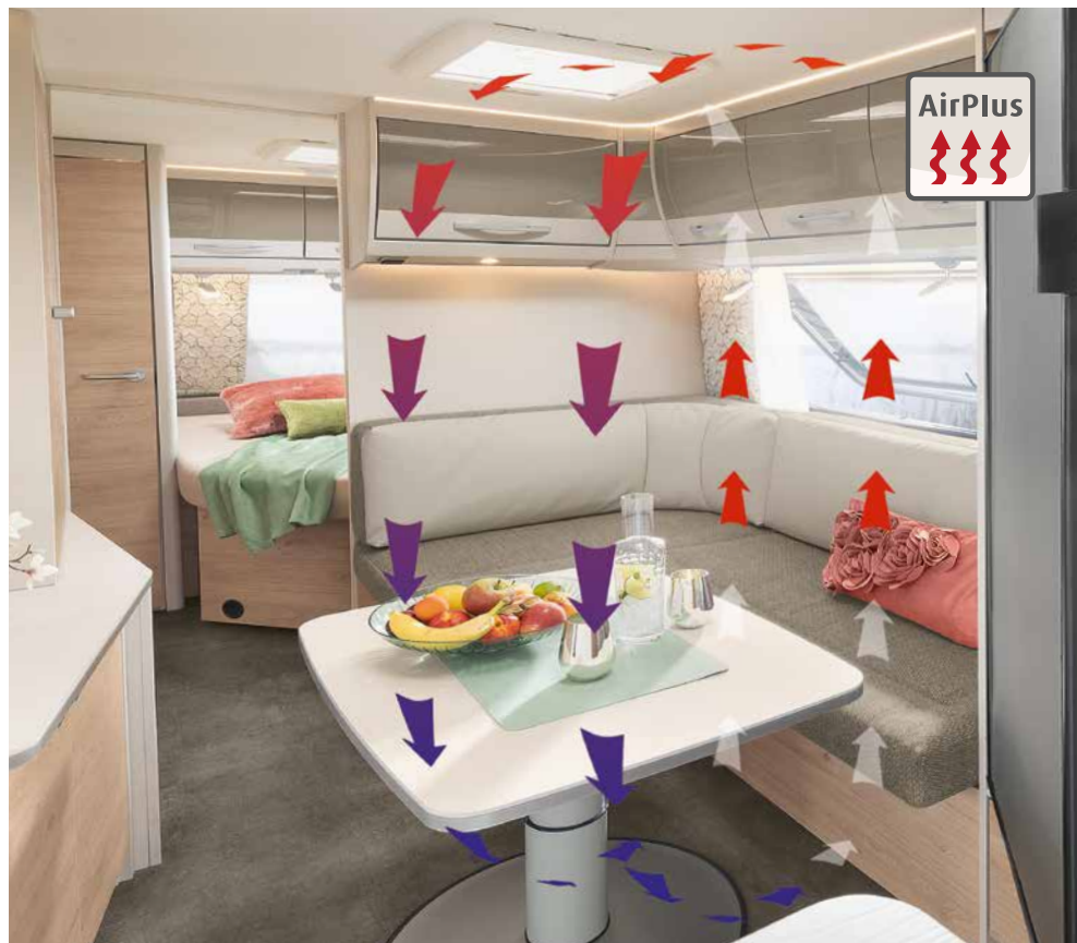
AirPlus ventilerer bag overskabene og forhindrer således, at der dannes kondens
